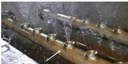
Fig. 8: Disturbed fan jet
